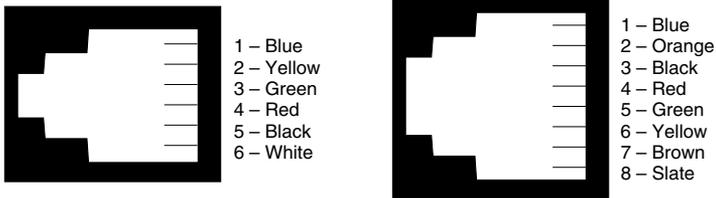
**Figure 4-1. AT&T® standard modular color codes.**
