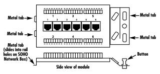
Figure 2-1. 6-Port CAT5e 568B Data Module.
