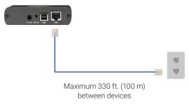
FIGURE QS-1. CONNECT THE LOCAL EXTENDER TO A NETWORK SWITCH
