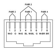
FIGURE 6-3. T568B CONNECTOR PINOUT
