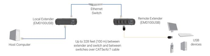
FIGURE 3-1. EMD100USB INSTALLED ON A LOCAL AREA NETWORK
