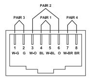
FIGURE 6-2. T568A CONNECTOR PINOUT
