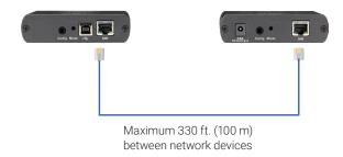
FIGURE QS-5. CONNECT THE LOCAL EXTENDER TO THE REMOTE EXTENDER
