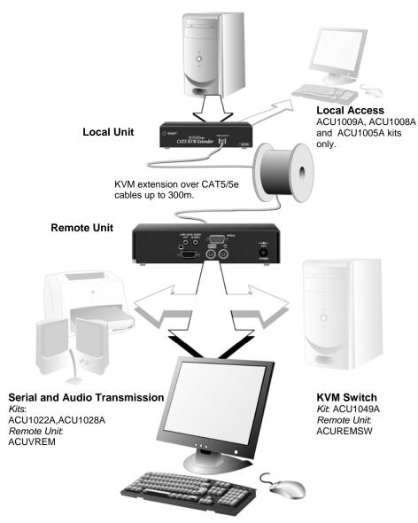
Figure 1 ServSwitch<sup>TM</sup> Brand CAT5 KVM Extender system
