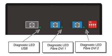
$Diagnostic\ LEDs\ at\ the\ ACS1xxA-Extender\ (Fibre\ Sockets)$
